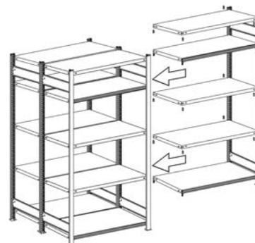
Die Breitenverbinder für das 2. Stahlregal werden in das bestehende 1. Stahlregal eingehängt.
