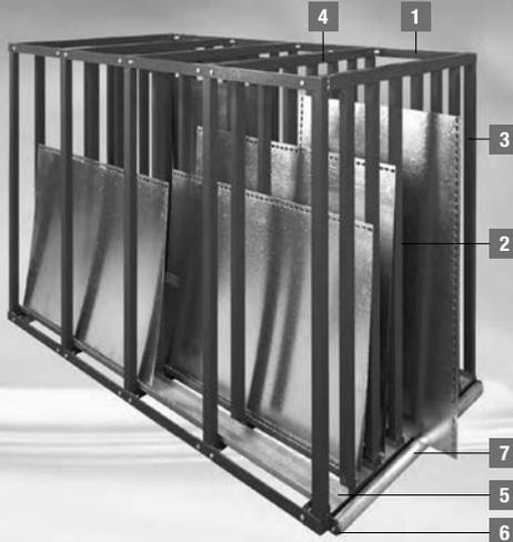
1. Seitenrahmen links (1) 2.500 x 1.500 x 30 mm (senkrechte Streben innen bündig) mit 2 Stück Rahmen außen (3) – Befestigungslaschen einseitig – verschrauben 8 x Sechskantschrauben M 8 x 45 mm ; 8 x Muttern M8). Es ist darauf zu achten, dass das Rahmenprofil 50 x 30 mm im Gebrauchszustand unten montiert wird.
